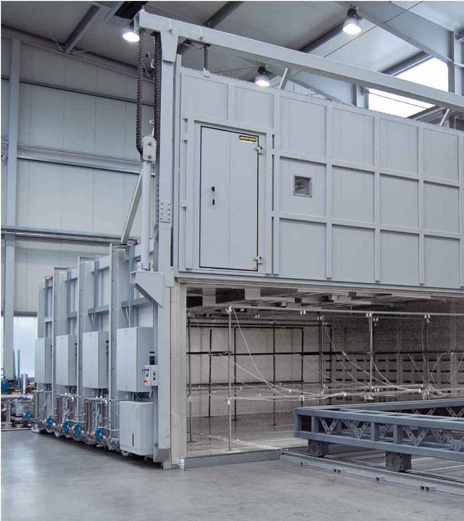
Horno de cámara con circulación de aire N 140000/26AS para el endurecimiento de materiales compuestos reforzados con fibras en sacos de vacío incl. bomba y conexiones necesarias en la cámara del horno
