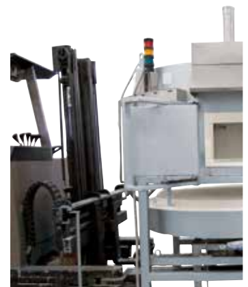
La base del horno puede bajarse para facilitar las tareas de mantenimiento
