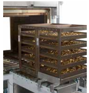
Horno continuo para material a granel en cestas
