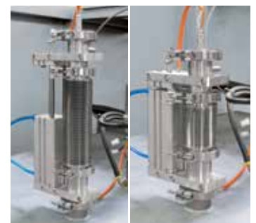
Termoelementos tipo S con dispositivo de retirada automático, para garantizar buenos resultados de medición en el rango de temperatura más bajo
