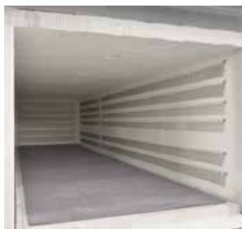
Aislante de fibra y resistencias en forma curvada para tiempos de proceso cortos
