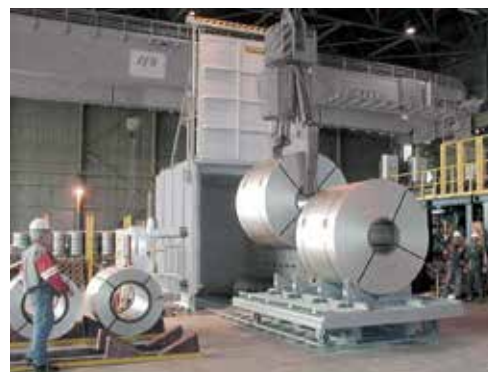
Horno de vagoneta con circulación de aire para el tratamiento térmico de bobinas
