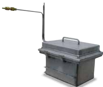
Caja de recocido con entrada y salida de gas protector y sistema de evacuación en frío
