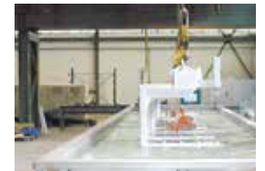
Baño de enfriamiento por agua con potente circulación de agua
