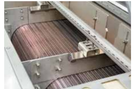
Accionamiento con cinturón de transporte por alambre en un horno continuo D 1100/3600/100/50 AS
