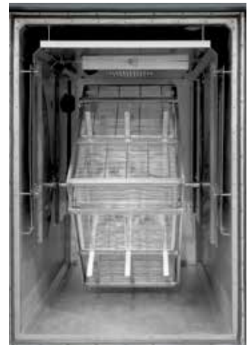
Dispositivo de giro a motor con cesto integrado para mover la carga durante el proceso de tratamiento térmico
