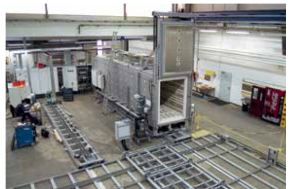
Sistema de horno con sistema de desplazamiento de vagonetas para la producción
