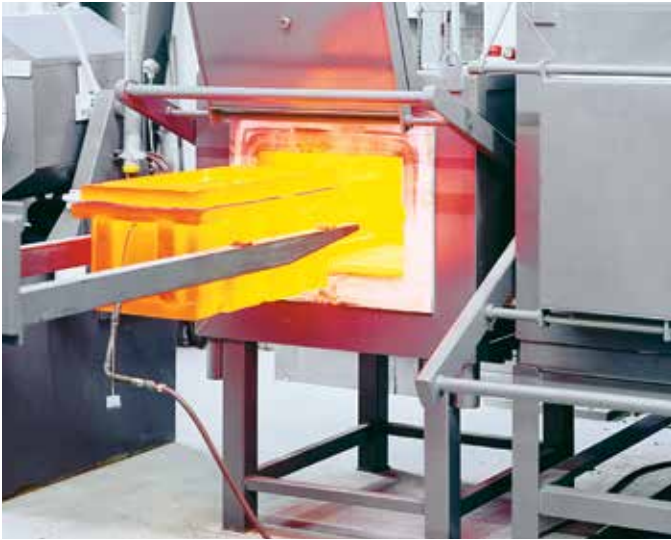
Nitruración con polvo en cajas de recocido
