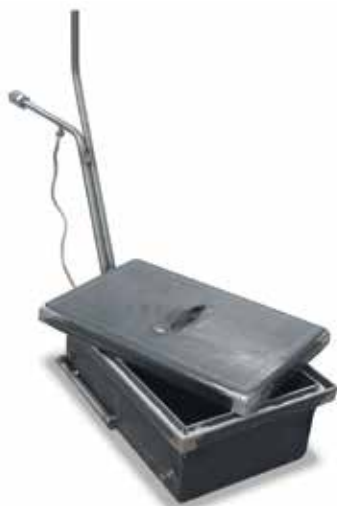
Caja de recocido con entrada y salida de gas protector
