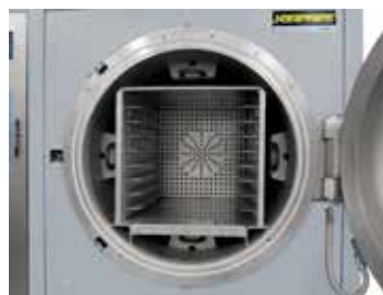
Retorta con calefacción interna y cámara de proceso
