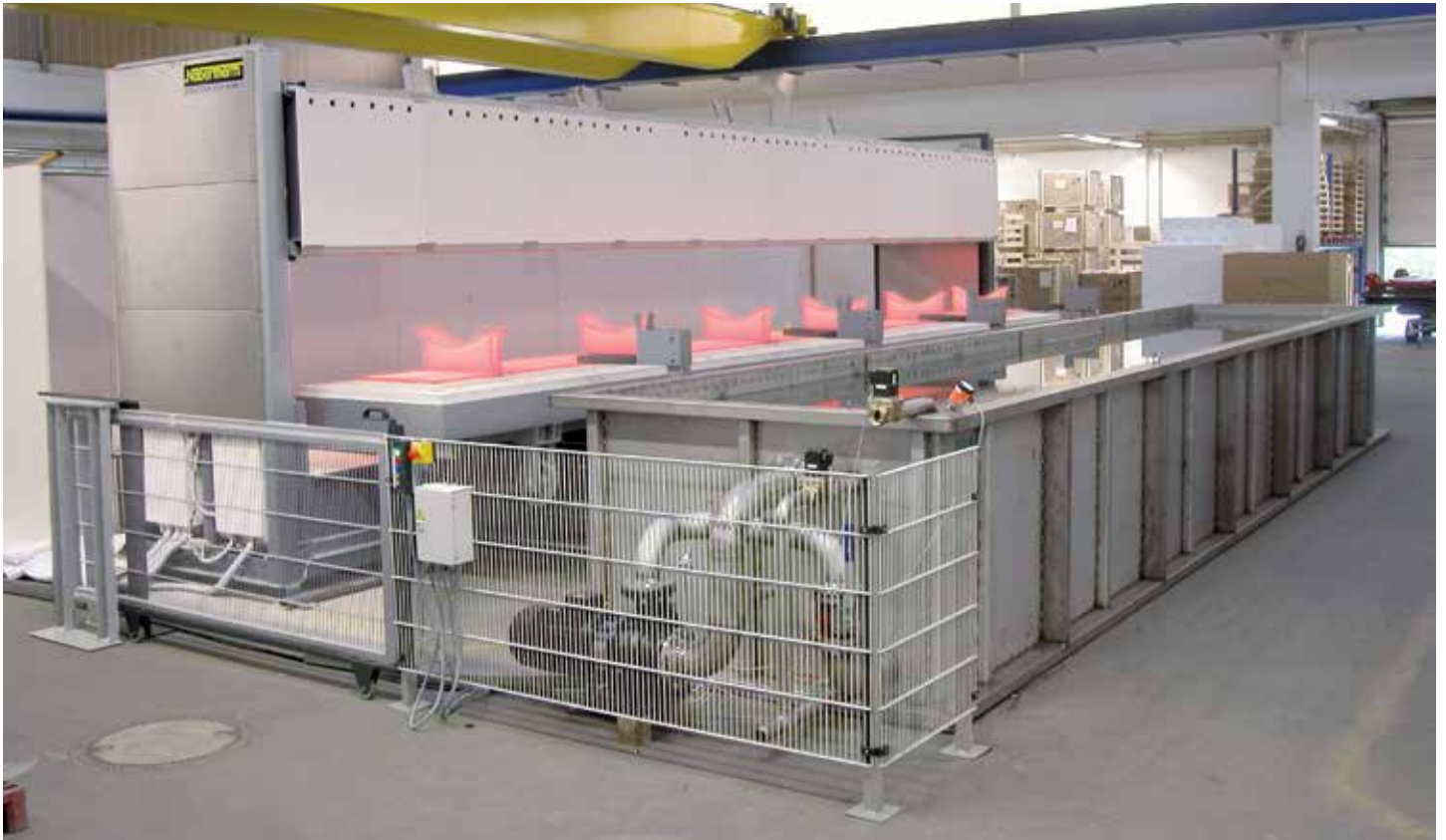
Equipo de revenido con horno de campana H4263/12S y baño de agua
