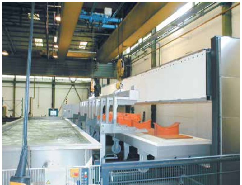
Instalación manual para equipo de revenido para revenir barras de acero véase página 74/75
