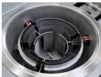
Retorta cilíndrica con calefacción de wolframio
