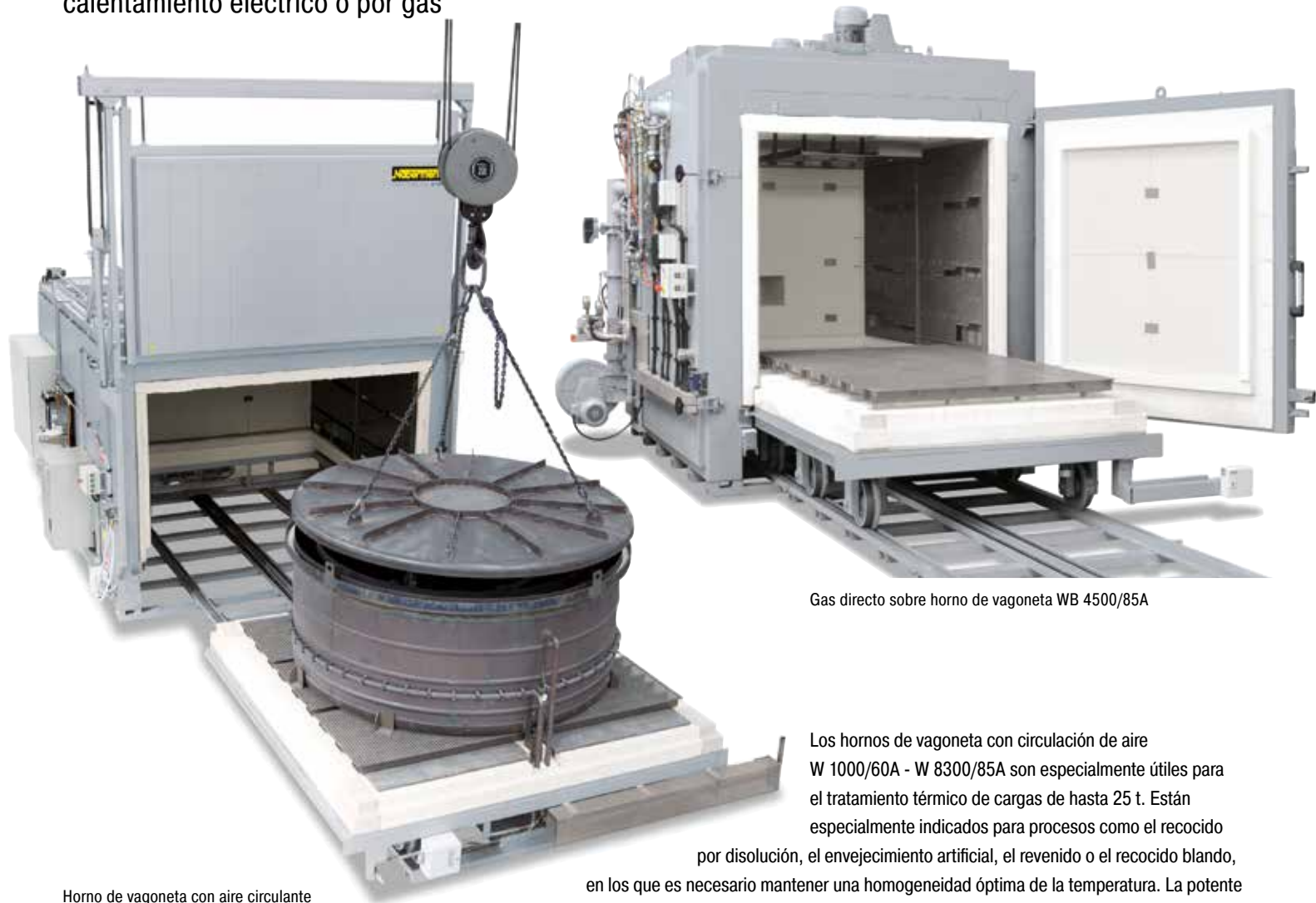
Horno de vagoneta con aire circulante W 5290/85 AS con caja de recocido para tratamiento térmico de bobinas bajo gas protector
