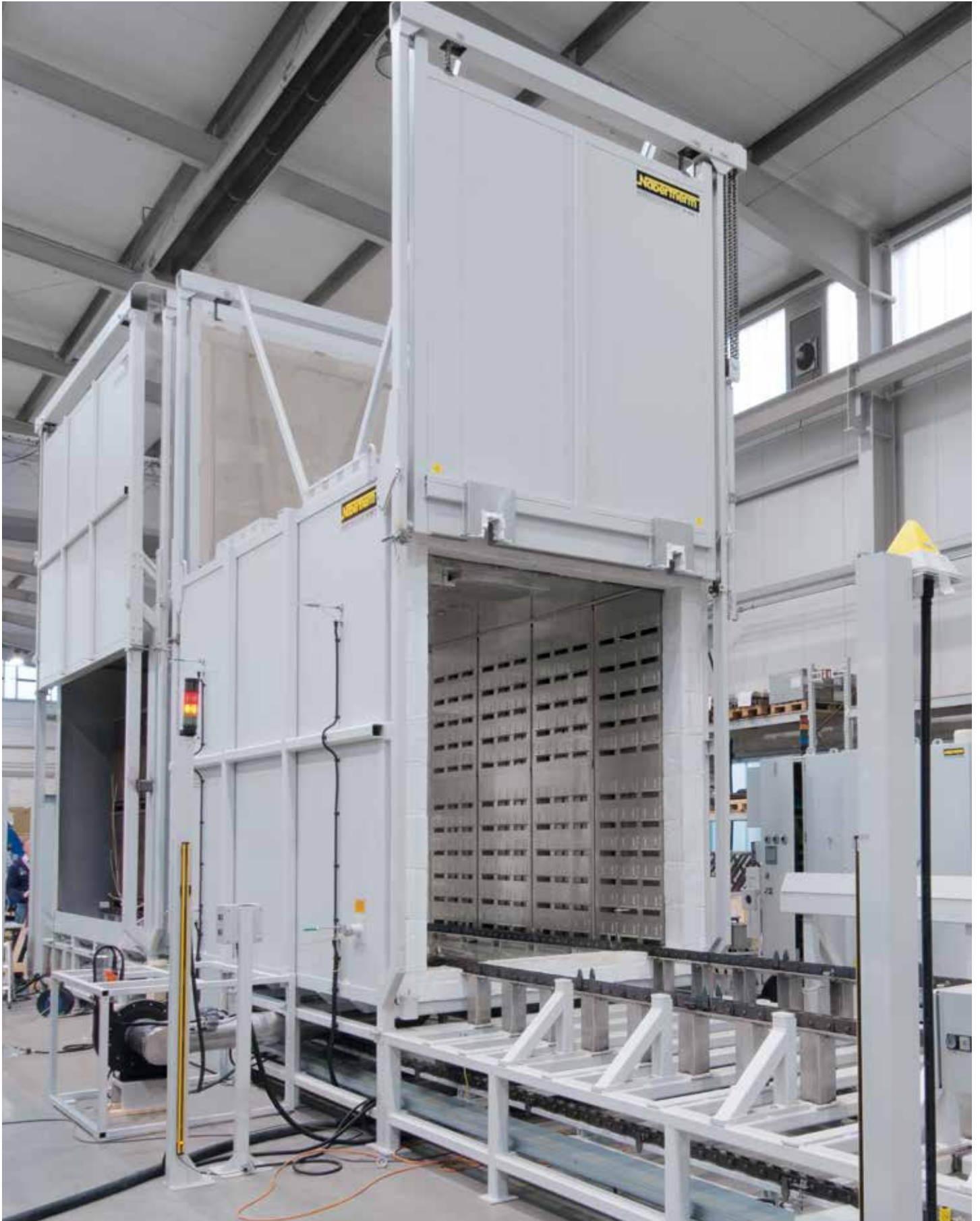
Instalación de horno continuo para temperaturas de trabajo de hasta 260 °C con posterior estación de enfriamiento
