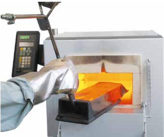
Proceso de temple con bolsa de recocido
