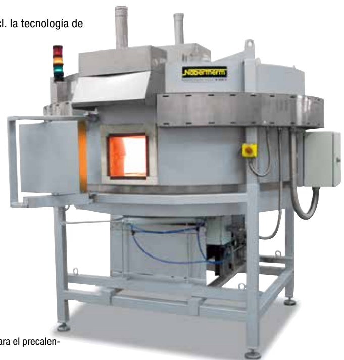
Accionamiento con cinturón de transporte por alambre en un horno continuo D 1100/3600/100/50 AS
