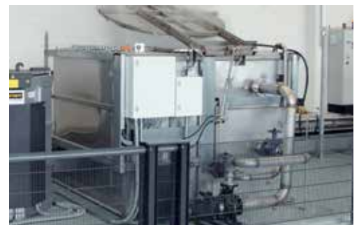
Baño de agua integrado en un equipo de revenido para aluminio
