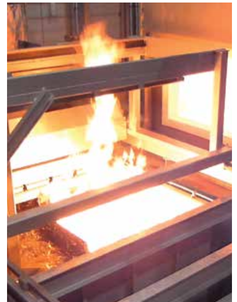
Un manipulador lleva la carga al horno caliente y la vuelve a sacar en caliente para llevarla al medio de enfriamiento
