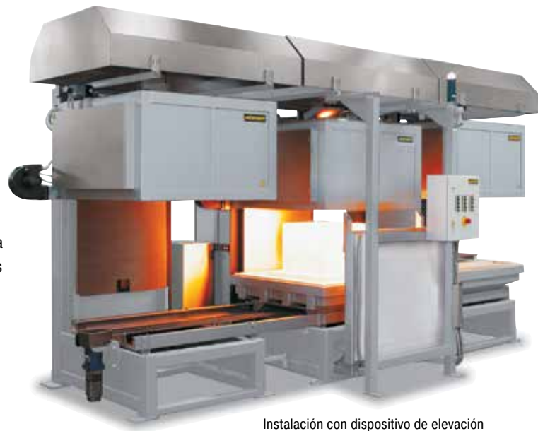
Instalación con dispositivo de elevación superior H 245/LTS con unidad refrigeradora y dispositivo de intercambio de mesas
