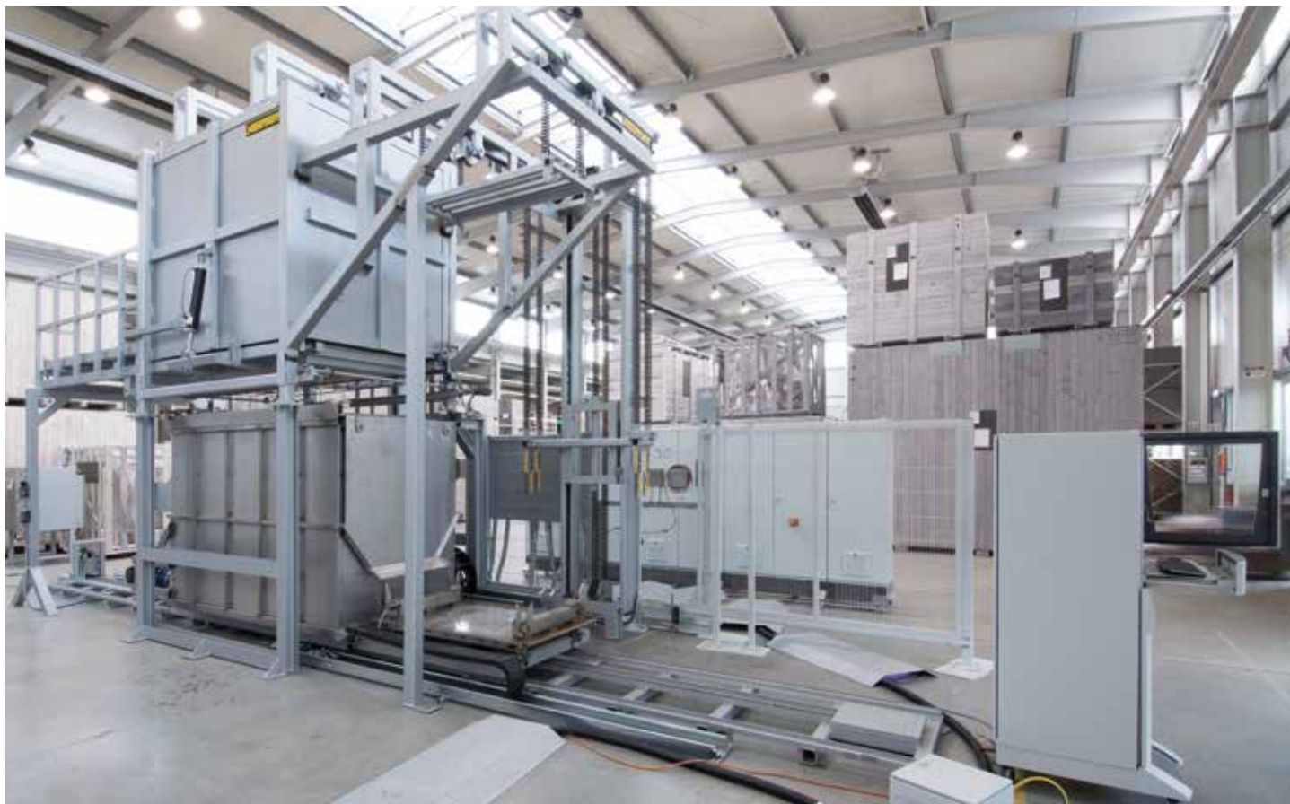
Horno de apertura inferior totalmente automático con baño de agua móvil incl. puesto de estacionamiento para cargar y grúa de descarga
