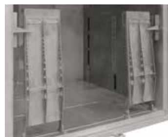
Rampas de introducción para hornos con aislamiento de base para procesos con elevados requisitos en cuanto a la homo- geneidad de la temperatura
