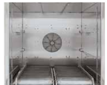
Transportador de rodillos en el horno de cámara con circulación de aire N 250/85HA
