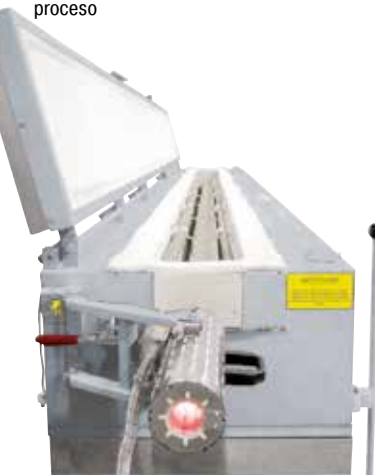
Horno para recocer alambres continuos en base a un horno tubular con una longitud de 6 metros
