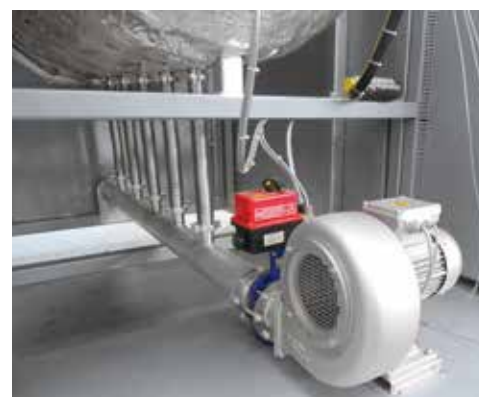
Refrigeración por ventilador, del horno de retorta de pared caliente NRA 400/03
