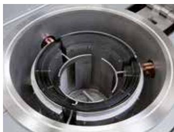
Retorta cilíndrica con calefacción de wolframio
