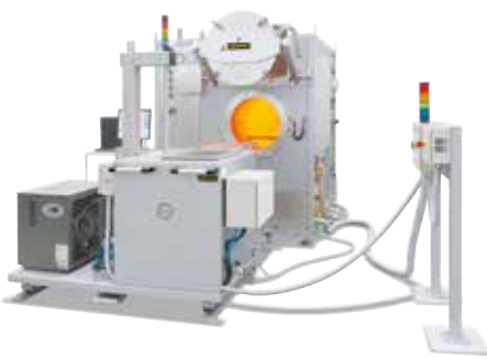
Horno de pared caliente con retorta NR 50/11 con dispositivo de enfriamiento semiautomático para el templeado de acero o titanio.
