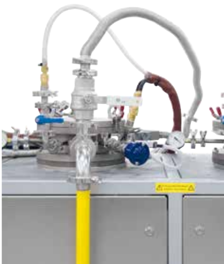
Retortas de recambio con conductos de alimentación y de medición
