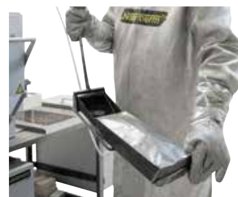
Utilización de bolsas de recocido para la inyección de gas
