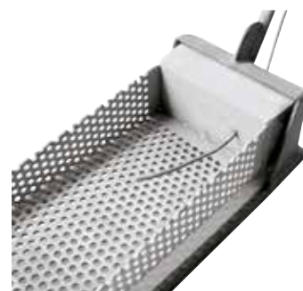
Termoelemento en el soporte
