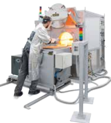
Equipo de revenido semiautomático con horno de retorta NR 50/11 y baño de enfriamiento por agua en un sistema de rieles
