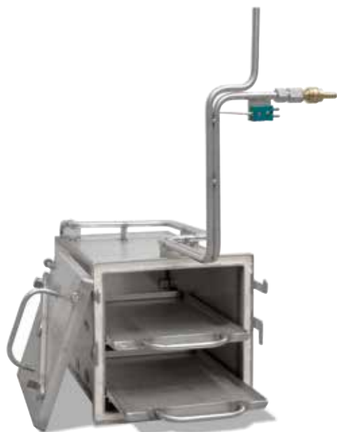
Caja de gasificación con módulos extensibles
