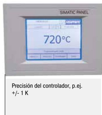
La precisión del sistema resulta de la adición de las tolerancias del controlador, del elemento térmico y del espacio útil
