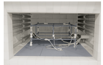
Estructura de medición en un horno de recocado
